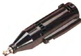
L'appareil Abisofix fonctionne en tension minimale (longue durée de vie sans danger électrique). Il est relié au réseau par le transformateur. Les couteaux en métal dur de la tête de dé-nudage de votre Abisofix forment un cône d'entrée. Vous introduisez le fil émaillé entre les 3 couteaux jusqu'à la longueur de dénudage voulue. Vous mettez ensuite l'Abisofix en route, puis vous le retirez. Vous obtenez un fil dénudé proprement.
