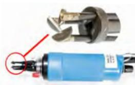
**Les appareils à dénuder "ABISOREX"** sont des appareils légers, faciles à manipuler, pour le dénudage aisé, rationnel et propre des fils émaillés, fils guipés verre, isolés matières plastique, guipés coton etc...
